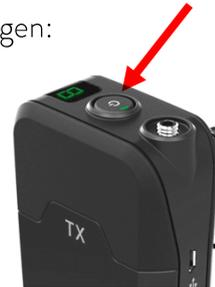
2. Prüfen Sie, ob der Sender verbunden ist (die Channel-Anzeige A1 oder A2 darf nicht blinken). Wenn dies doch der Fall sein sollte und keine Verbindung zum Mikrofon-Empfänger hergestellt werden kann, finden Sie in der Betriebsanleitung „Verbindung mit dem Rode Filmmaker-Mikrofon“ weitere Informationen zum Umgang mit den Lavaliermikrofonen.
